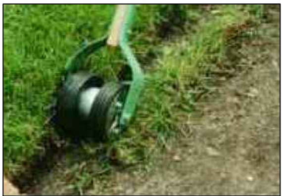
Celiņu malu kopšanas instruments izteiktas celiņa malas veidošanai, zāliena velēnas nogriešanai
