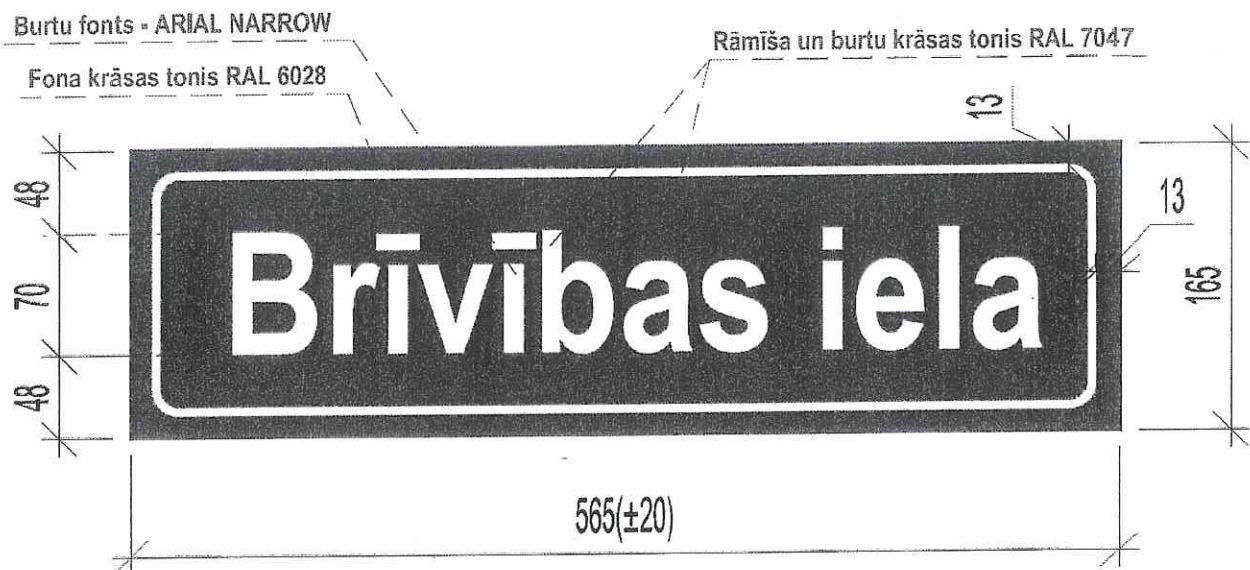
Norāžu staba augstums 3,0m, cinkots. Attālums no zemes virsmas līdz plāksnītei ne mazāks par 2,50m. Norādes plāksnītes fona krāsa RAL 6028, ārējā rāmīša un burbu tonis RAL 7047, izgatavots no atstarojošas līmplēves. Burbu fonts – ARIAL vai ARIAL NARROW.
