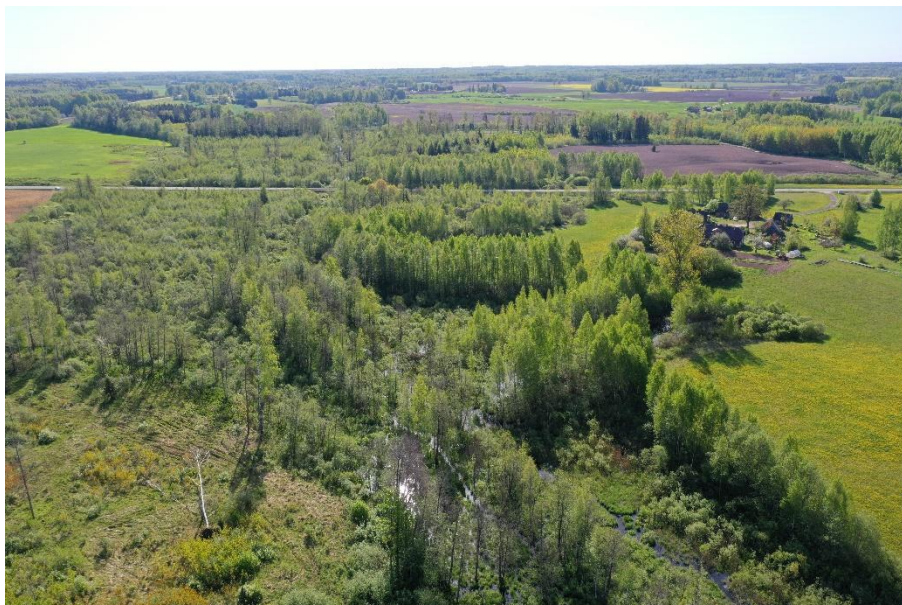
2.3.6. attēls. Priekulānu grāvis starp reģionālas nozīmes ceļu P74 Siliņi-Aknīste un ieteku Priekulānu ezerā. Ieslīpā aerofotogrāfija ar BGK, skats no A-ZA. Bebru darbības rezultātā grāvī paaugstināts ūdens līmenis un applūdušas zemākās vietas ( X_{LKS-92TM} = 610254 un Y_{LKS-92TM} = 246808 ) (Foto: J. Soms)
