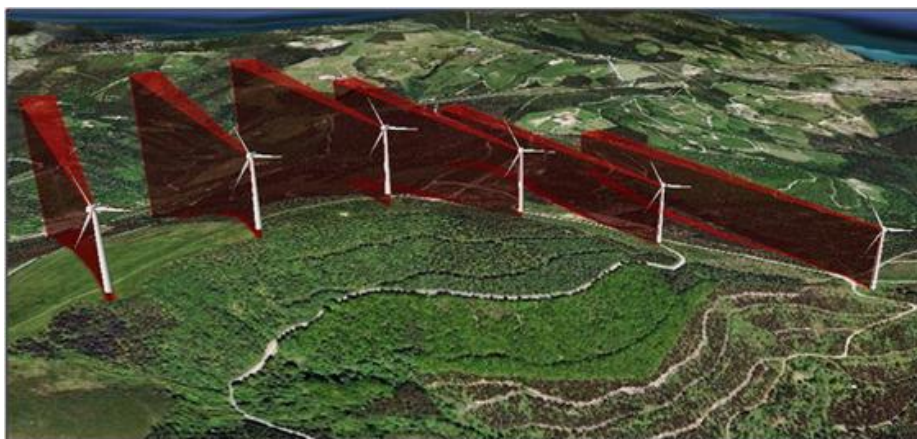
3.11.1. attēls. Aprēķinu piemērs par VES radītu zonu, kurā tiek bloķēts radara stars
